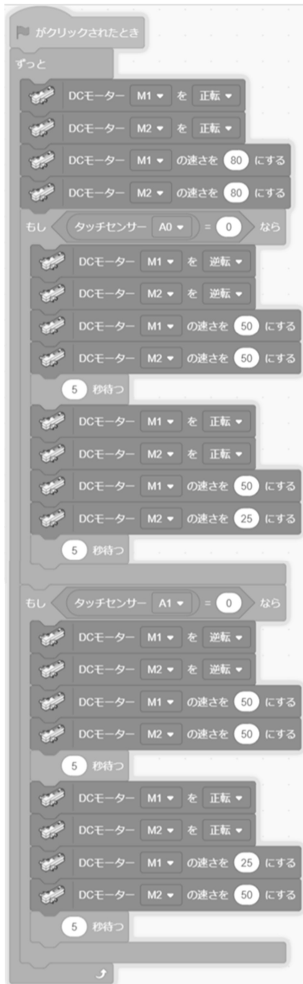
図：タッチセンサの反応に合わせて右左折をするプログラム(参考にしてください)
