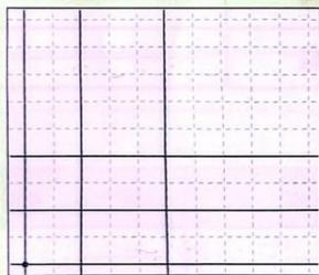
① 正面図の基準となる点を決めて、水平線と垂直線をかく。正面とする面を決めて、その形を表す下がり線をかく。
